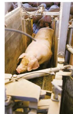
体重を自動計測し、出荷を判別するソートシステムで、豚のストレスを軽減する
